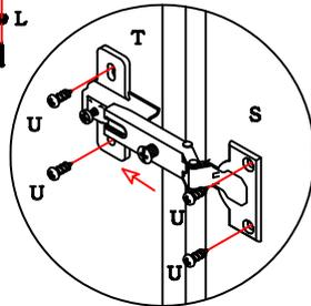
A dobradiça "S" deve ser encaixada no calço "T" e estes colocados com os parafusos "U", observando o procedimento a cima.
