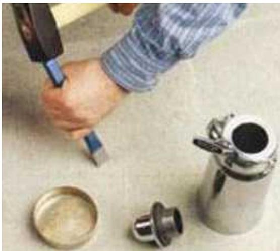
Utilize uma marreta e talhadeira. As amostras devem ser reduzidas a pó com auxílio de um martelo ou similar, antes de colocar no aparelho, são colocadas dentro do aparelho de medição, com a esfera de aço e a cápsula de carbureto de cálcio. Ao movimentar o aparelho e romper a cápsula de carbureto de cálcio, dá-se uma reação química e o aparelho mede a quantidade de água presente na amostra.
