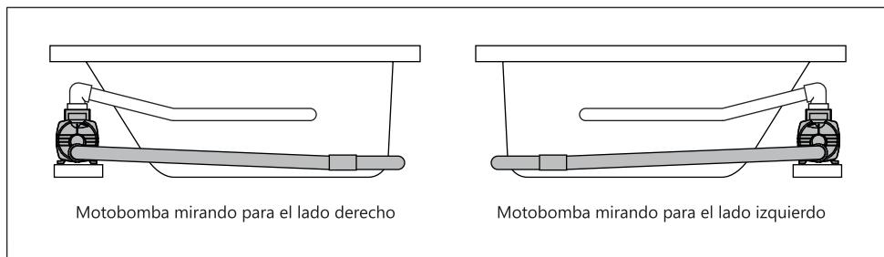
La tubería de succión puede ser montada con la motobomba mirando para la derecha o para la izquierda (figura arriba), de acuerdo con la necesidad de la obra, de modo que el delantero de la motobomba quede mirando para la puerta de inspección, para facilitar el acceso y mantenimiento.
