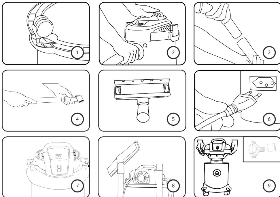
1. **RODÍZIOS:** Encaixe os rodízios na base de seu aspirador (se necessário com o auxílio do martelo de borracha) e bata levemente no local indicado até o encaixe total do rodízio.
