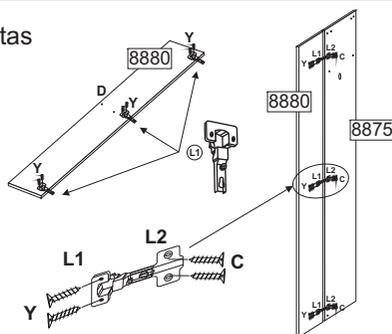
Após fixar a dobradiça(L1) a porta(8880 / 8881/8882) e (L2) a laterais (8875/8867) e divisão (8878/8879) faça a junção das duas peças, fixando uma na outra com parafuso próprio, após o encaixe faça a regulagem da apertando ou folgando o parafuso para que a porta fique firme e bem posicionada.
