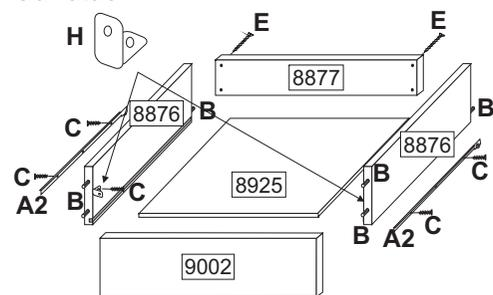
Gavetas - Parafusar as laterais de gaveta ao lenço da gaveta com o parafuso (E); encaixar o fundo no rasgo e fixe a frente com a cavilha (B) e cantoneira (U); a corrediça (A2) deve ser parafusada na lateral (8876) com o parafuso (C) na posição horizontal.
