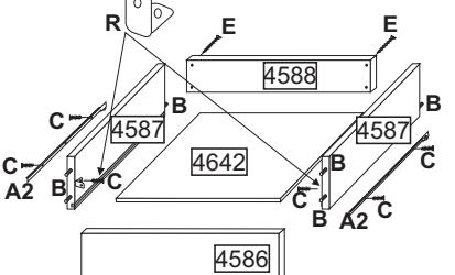
Gavetas - Parafusar as laterais de gaveta (4587) ao lenço da gaveta (4588) com o parafuso (E); encaixar o fundo e fixar a frente (4586) com cantoneira (R); a corrediça (A2) deve ser parafusada na lateral (4587) com o parafuso (C) na posição horizontal como mostra a imagem.
