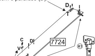
Posicione a Parada plástica (V) nas portas esquerdas (7723 e 7724) na direção da fechadura (%) e fixe com o parafuso (C).
