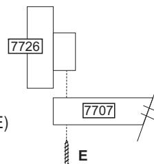
**Moldura** - Parafusar a moldura com parafuso (E) ao tampo(7707).
