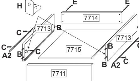
**Gavetas** - Parafusar as laterais de gaveta ao lenço da gaveta com o parafuso (E); encaixar o fundo no rasgo e fixe a frente com a cavilha (B) e cantoneira (H); a corrediça (A2) deve ser parafusada na lateral (7713) com o parafuso (C) na posição horizontal.
