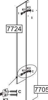
Após encaixar a dobradiça(K1) e parafuse-as a porta(7719, 7720, 7723 e 7724) e (K2) a lateral (7704 e 7667) e a divisão (7705 e 7706) faça a junção das duas peças, fixando uma na outra com parafuso próprio da mesma, após o encaixe faça a regulagem apertando ou folgando o parafuso para que a porta fique firme e bem posicionada.
