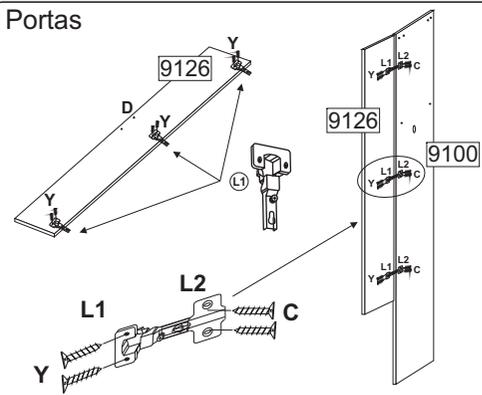
Após fixar a dobradiça(L1) a porta(9126/9127) e (L2) a lateral (9121) e divisão (9100) faça a junção das duas peças, fixando uma na outra com parafuso próprio, após o encaixe faça a regulagem da apertando ou folgando o parafuso para que a porta fique firme e bem posicionada.
