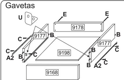
**Gavetas** - Parafusar as laterais de gaveta ao lenço da gaveta com o parafuso (E); encaixar o fundo no rasgo e fixe a frente com a cavilha (B) e cantoneira (U); a corrediça (A2) deve ser parafusada na lateral (9177) com o parafuso (C) na posição horizontal.
