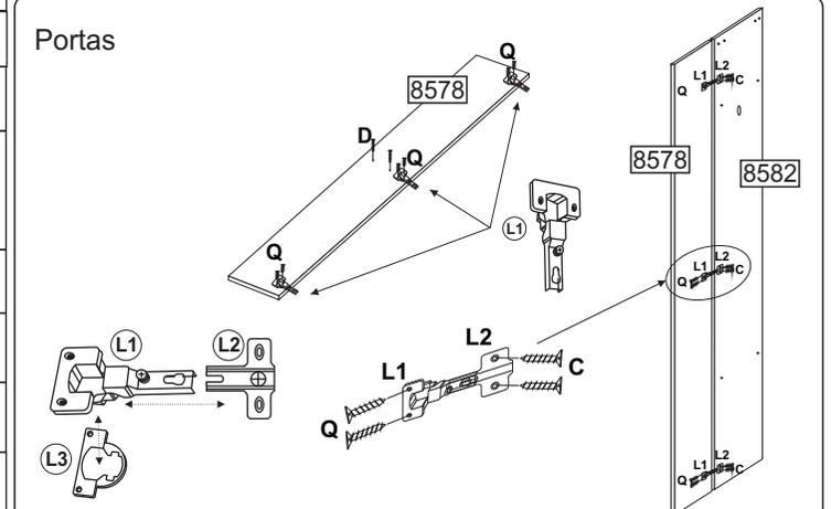
Após encaixar a dobradiça(L1) ao calço 07 (L3) parafuse-as a porta(8578) e (L2) a divisão (8582) e a lateral (8563) faça a junção das duas peças, fixando uma na outra com parafuso próprio da mesma, após o encaixe faça a regulagem apertando ou folgando o parafuso para que a porta fique firme e bem posicionada.
