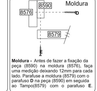
**Moldura** - Antes de fazer a fixação da peça (8590) na moldura (8576), faça uma medição deixando 12mm para cada lado. Parafuse a moldura (8579) com o parafuso D na peça (8590) em seguida ao Tampo(8579) com o parafuso E.
