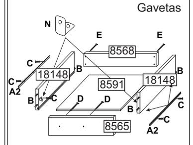
**Gavetas** - Parafuse as laterais de gaveta(8564) ao lenço da gaveta (8568) com o parafuso E e cavilhas B; encaixar o fundo e fixe a frente (8565) com cavilha B e cantoneira N mais parafuso C; a corrediça A2 deve ser parafusada na lateral(18148) com o parafuso C na posição horizontal como mostra a imagem e parafuse o puxador I na frente de gaveta com o parafuso D.
