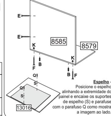
**Espelho** - Posicione o espelho alinhando a extremidade do painel e encaixe os suportes de espelho (S) e parafuse com o parafuso Q como mostra a imagem ao lado.
