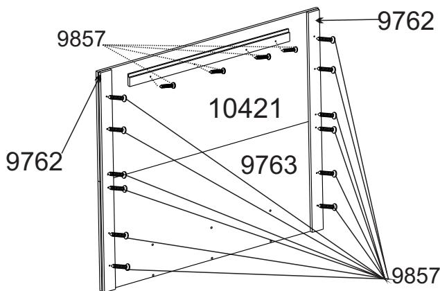
**2** Fixe o suporte painel (9764) nos painéis utilizando parafuso (9857).
