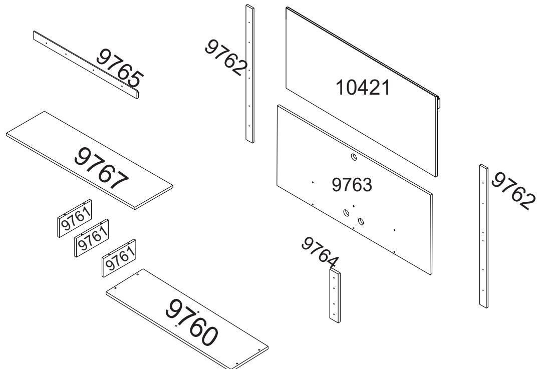
**1** Junte os painéis (10421/9763) e fixe a trava junção (9762) utilizando parafuso (9857). Em seguida, coloque o parafuso (9857) no painel sup. montado para dar um pouco mais de firmeza e segurança ao seu produto.
