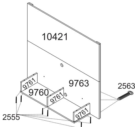
**4** Fixe o tampo (9767) no painel (9763) com parafuso (2563) e sobre a lateral divisão (9761) utilizando parafuso (2555). Em seguida, fixe o suporte (9765) na parede com bucha (9858) e parafuso (9856).
