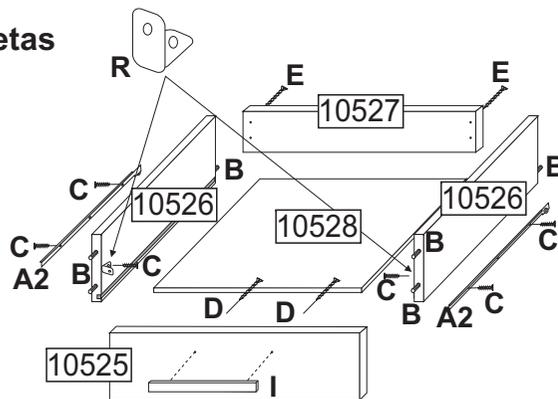
**Gavetas** - Parafusar as laterais de gaveta (10526) ao lenço da gaveta (10527) com o parafuso (E); encaixar o fundo e fixar a frente com cantoneira (R); a corrediça (A2) deve ser parafusada na lateral (10519) com o parafuso (C) na posição horizontal como mostra a imagem.
