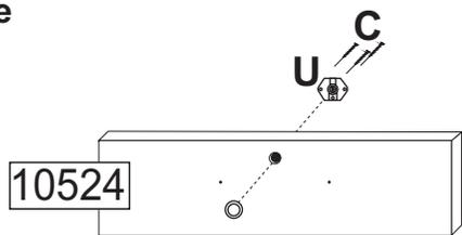
Desencaixe a tampa da fechadura, posicione a fechadura (U) de dentro para fora da frente de gaveta (10524) e parafuse com o parafuso (C) e encaixe a tampa da fechadura e a chave.
