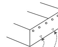
Obs: Se for usado como plafon sobrepor, fechar os furos laterais que são usados para a fixação da mola, com o tampa furo do kit.
