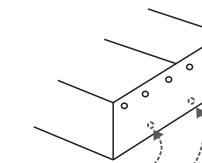
Obs: Se for usado como plafon sobrepor, fechar os furos laterais que são usados para a fixação da mola, com o tapa furo do kit.
