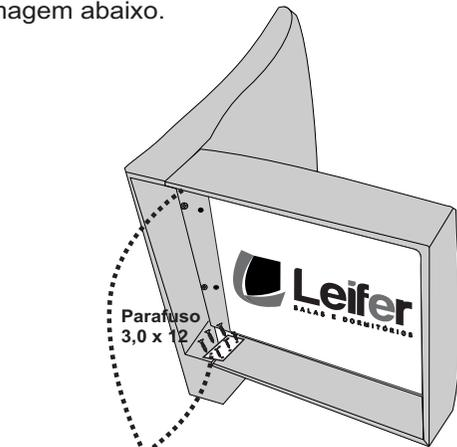
Facear bem o encosto com o assento, para fixar a chapa 06 furos. Nas duas laterais do assento com o encosto.
