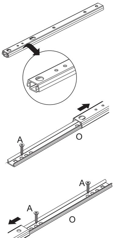
Antes de fixar a corrediça verifique a posição correta conforme mostra o detalhe. Veja que o topo que deve ficar para a frente possui dois furos bem próximos, esses furos devem ficar para a frente do móvel.
