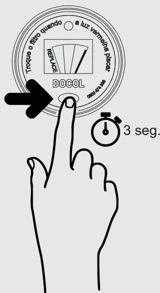
Após ativado o botão, a barra indicadora no visor irá progredir ao longo do tempo, indicando a substituição, quando chegar ao final.
