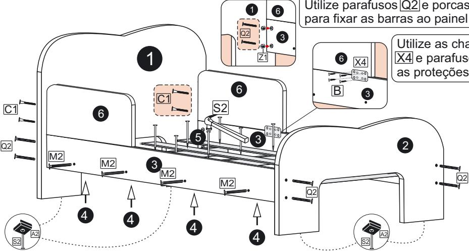
Utilize parafusos **Q2** e porcas cilíndricas **Z1** para fixar as barras ao painel e à pezera.
