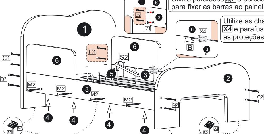
Utilize parafusos **Q2** e porcas cilíndricas **Z1** para fixar as barras ao painel e à pezera.
