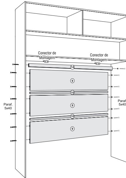
**4** Montagem da moldura do MÓDULO AEREO.
