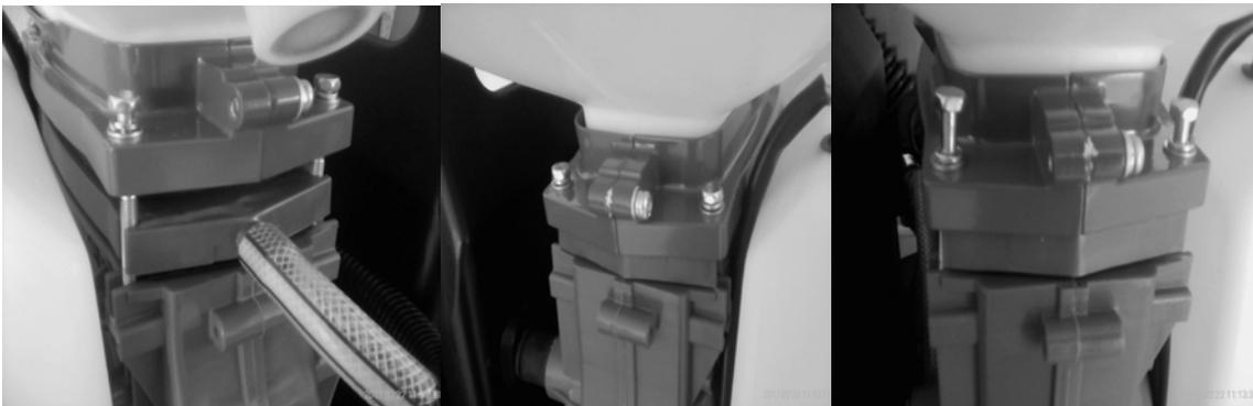
Logo retirando os parafusos de fixação levante o reservatório de seu local e vai perceber a placa de líquidos apenas encaixada sobre o corpo da máquina.
