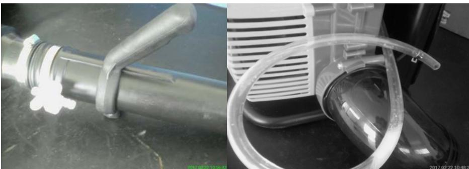
A mangueira transparente que sai da bomba de recalque na traseira interna do equipamento deverá ser conectada no registro de liquido junto ao tubo de ventilação.
