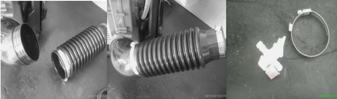
Afrouxe a braçadeira e encaixe o tubo sanfonado junto ao tubo curvado com na figura anterior.
