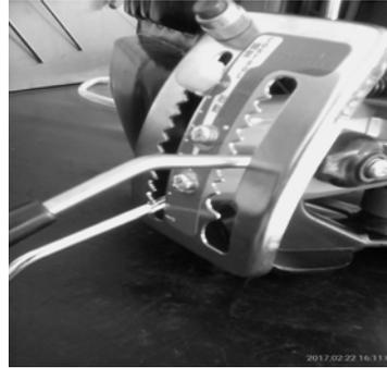
Em seguida coloque a alavanca do acelerador em meia aceleração como na figura.
