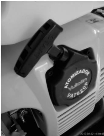
Após ligar a máquina mude o afogador para a posição do meio e retorne a alavanca do acelerador para uma posição mais abaixo de rotação. Deixe o motor aquecer de 1 a 2 minutos. Em seguida mude para a última posição onde deverá trabalhar normalmente o equipamento.
