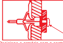
4 - Posicione o armário com a cantoneira sobre a bucha e fixe-o com um parafuso
