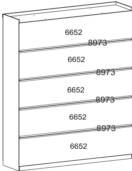
**10** Fixe as corredeiras (8911) nas divisões utilizando os parafusos (2503). Em seguida, fixe os suportes de cabideiro (2576) utilizando parafuso (2503). Fixe também a trava de gavetas (6737) utilizando cantoneira (8868) e parafuso (2503).
