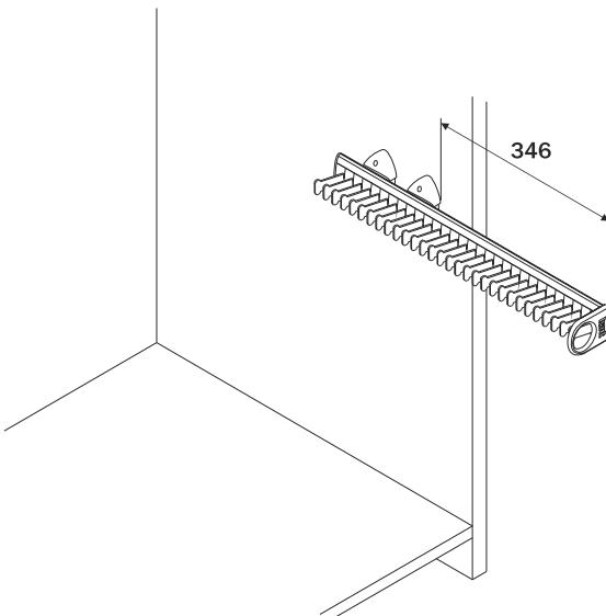
**1** Posicione o sistema na lateral, fixe utilizando 04 parafusos AACB3,9x20.
