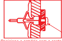
4 - Posicione o armário com a cantoneira sobre a bucha e fixe-o com um parafuso. Aperte o parafuso até a fixação estar segura
