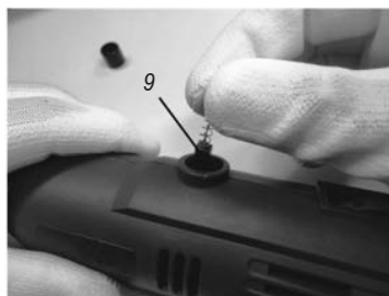
Fig. 6 – Sustitución de cepillo carbón
