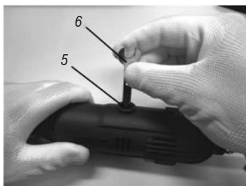
Fig. 6 – Sustitución de cepillo carbón
