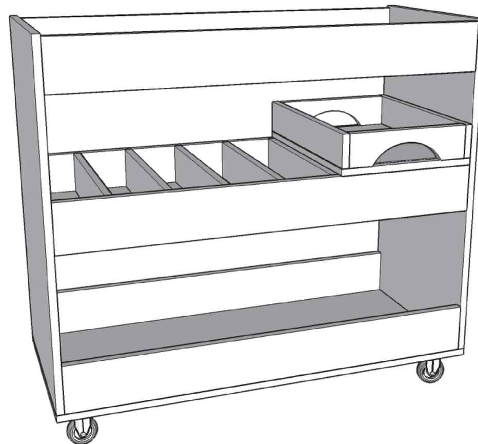
Dimensões do Rack: Altura: 0,77m | Comprimento: 0,91m | Profundidade: 0,40m
