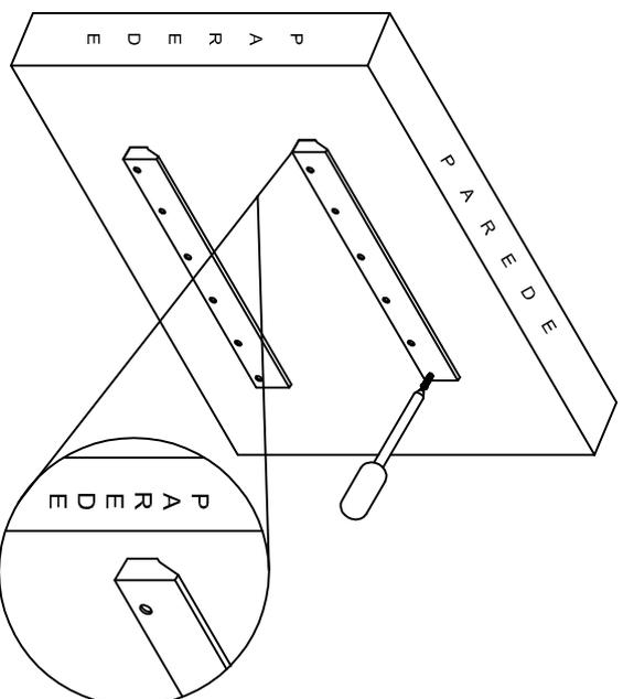
Parafuse a peça n°05 com o rebaixo virado para parede, com parafusos 5,0 x 80.
