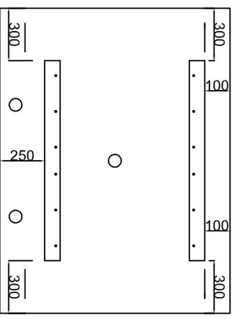
OBS: Medidas em Milímetros (mm) para a montagem dos suportes do painel e da parede.
