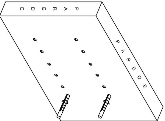
Fure a parede para fixação das buchas com broca de 8 mm (não inclusa no acessório)
