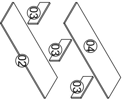
Fixar as peças 03 na peça 02 com cavilhas e minifix. Fixar a peça 04 nas peças 03 com cavilhas e minifix.
