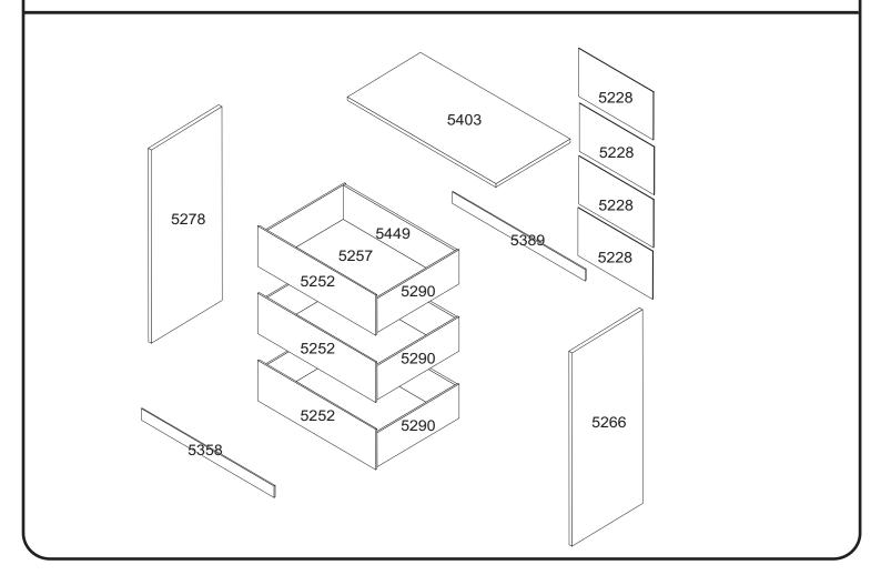
Fixe as sapatas (4617) com parafuso (10649). Fixe as laterais (5278/5266) com parafuso (2525) nos rodapés Em seguida fixe o tampo (5403) com a cantoneira 2 furos (2464) e parafusos (10649) e cavilha 2471.
