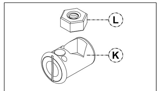
9º - Encaixe as buchas com as porcas nas furações da grade fixa, de modo que no momento da montagem o parafuso passe primeiro pela bucha e depois pela porca, conforme desenhos a seguir:
