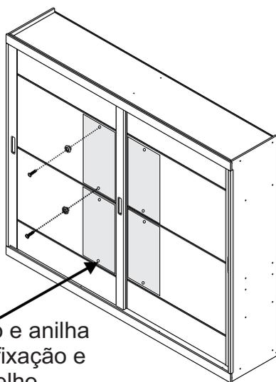
A utilização do parafuso e anilha serve para melhorar a fixação e segurança do espelho
