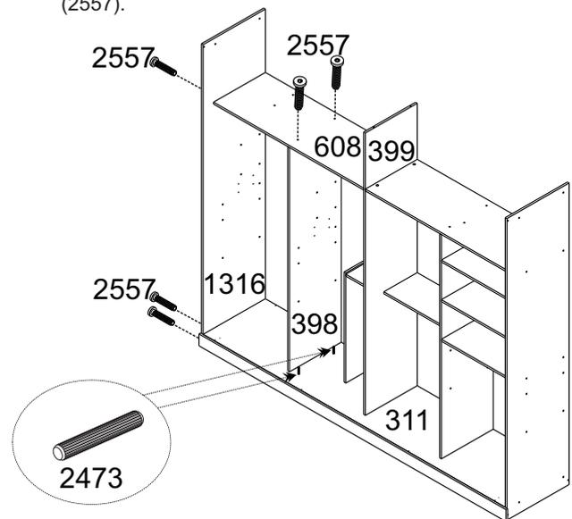
**6** Fixe as cavilhas (2473) na divisão (399). Em seguida, encaixe o tampo, (1355) e fixe-o nas laterais (1315/1316) com parafuso (2557).
