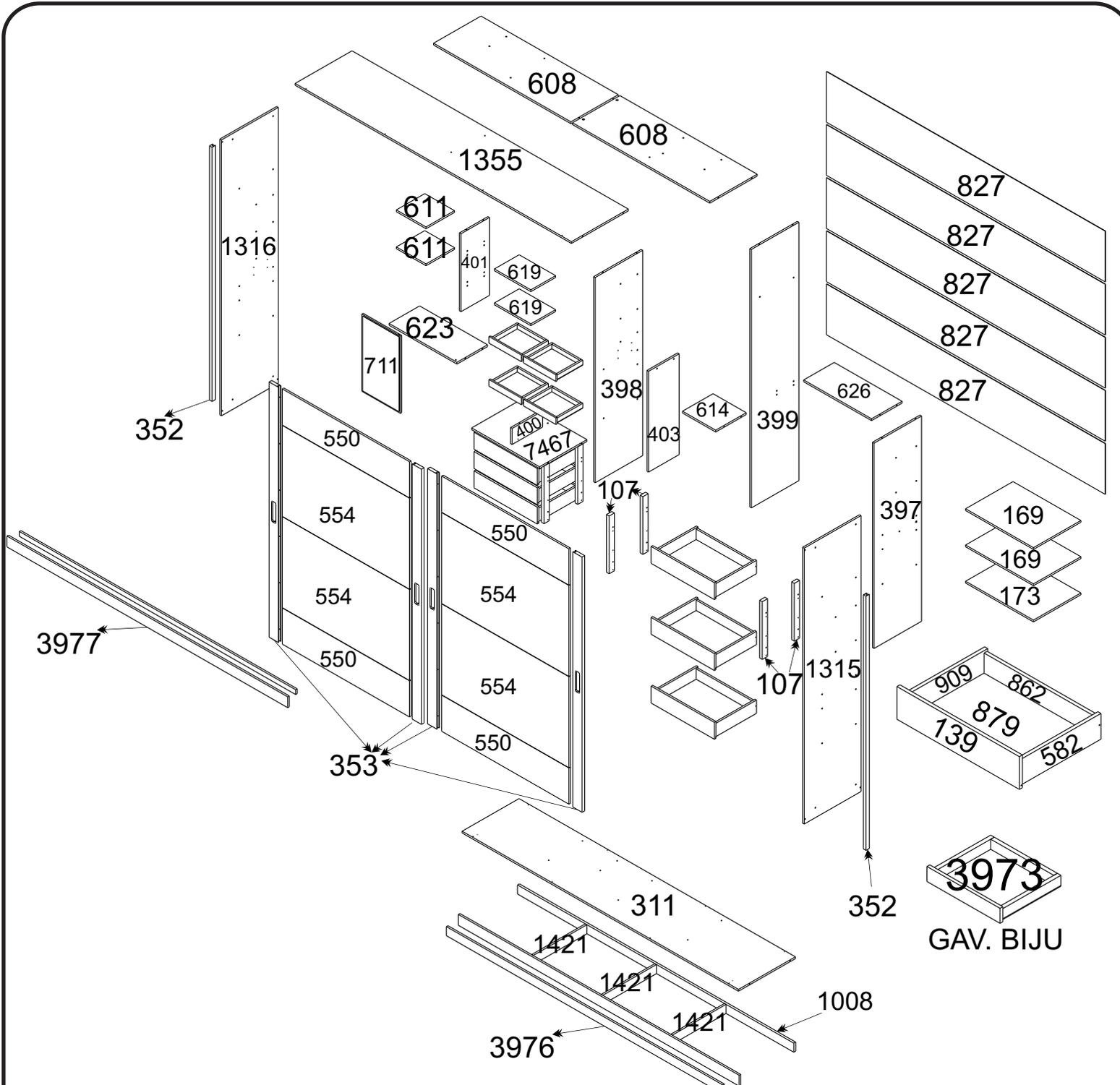
**1** Fixe as sapatas (2574) com parafuso (2504) nos rodapés (3976/1008). Em seguida, fixe as travessas (1421) aos rodapés (3976/1008), utilizando cantoneira 4 furos (2466) e o parafuso (2504). Fixe a base (311) nos rodapés e travessas utilizando parafuso (2505).
