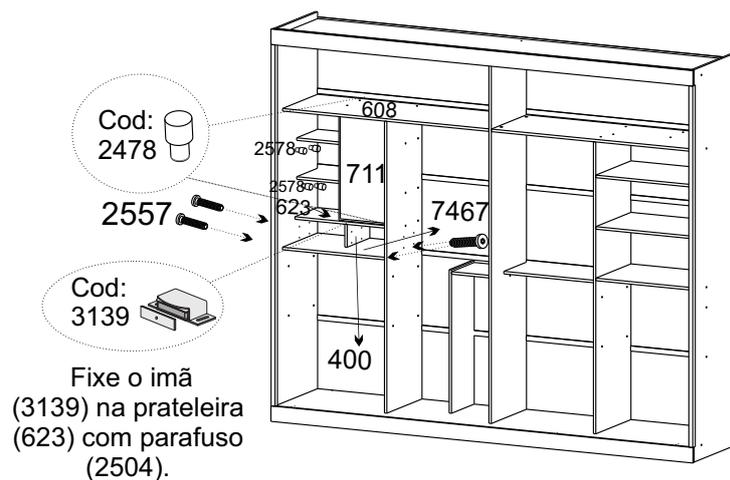
**12** Fixe o afastador (107) nas laterais e divisões com parafuso (2557). Em seguida, fixe as corredeiras (8905) com parafuso (2504) na divisão biju (400) e lateral (1316). Fixe também a corredeira (8910) com parafuso (2511) nos afastadores (107).
