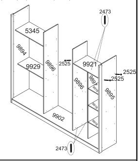
Fixe com parafuso (2525) a prateleira (9921) nas divisões (9896). Em seguida, fixe a divisão colmeia (9918) utilizando parafuso (2525). Coloque o suporte prateleira (2578) na divisão colmeia (9918) em seguida, apóie as prateleiras (9919) e fixe-as na divisão (9896) com parafuso (2525).
