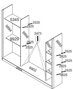
Fixe a divisão (9896) na base (9902) com cavilha (2473). Em seguida, fixe a prateleira (9921) utilizando cavilha (2473) e parafuso (2525).
