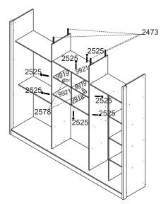
Fixe as cavilhas (2473) nas divisões (9896) como demonstra o desenho nº 7 e encaixe o tampo (9911). Com parafuso (2525) fixe o tampo nas laterais (9895/9894). Em seguida, prenda a moldura (9906) no tampo (9911) utilizando cantoneira angular (4619) e parafuso (9292).
