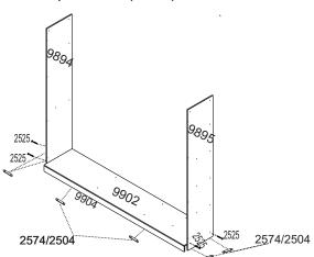
Fixe a coluna lateral (9903) nas laterais (9894/9895) utilizando parafuso (9857). Em seguida, fixe a divisão (9896) na base (9902) com cavilha (2473). Com parafuso (2564) fixe as colunas no rodapé (9904).
