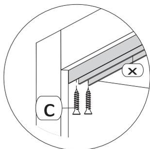
**INSTALE O TRILHO SUPERIOR ENCOSTADO ATRÁS DA COLUNA LATERAL**
