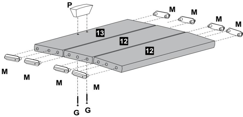
**G** Parafuso Ø3,5x25mm CF 02 **M** Deslizador 08 **P** Puxador Duna (32mm) 01
