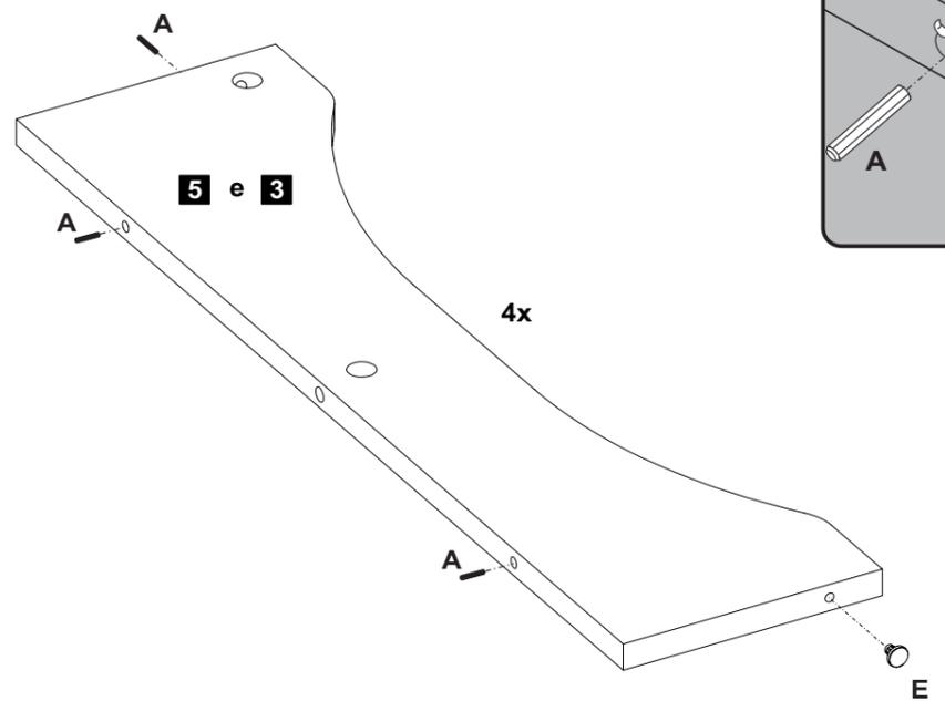
**A** Cavilha **12** **E** Sapata Fixa Ø5x10mm **04**
