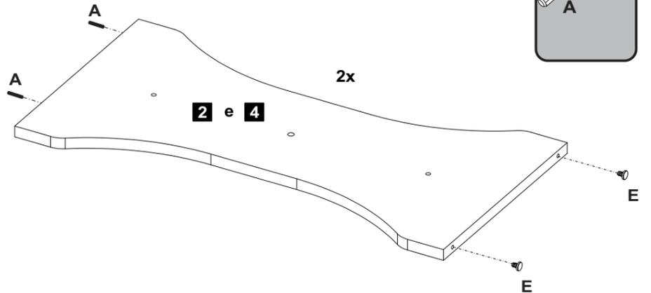
**A** Cavilha **08** **E** Sapata Fixa Ø5x10mm **04**
