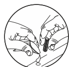
Detalhe fixação de cavilhas
