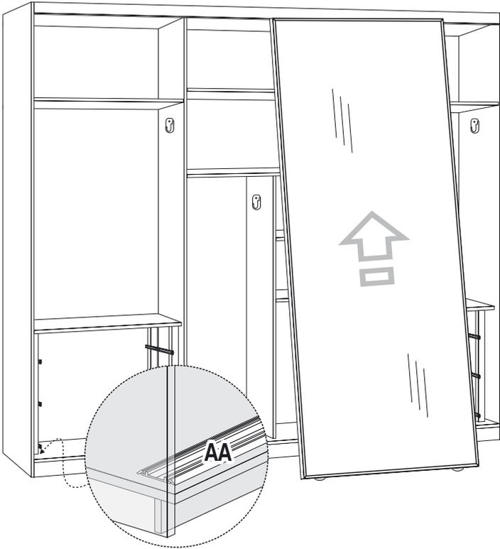
PRIMEIRO ENCAIXE A PORTA NO GUIA SUPERIOR E EM SEGUIDA ENCAIXE NO TRILHO INFERIOR, ALINHE A PORTA E PRAFUSE O TRILHO.
