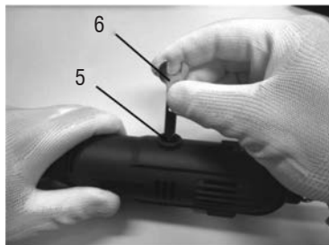
Fig. 6 – Substituição da escova de carvão
