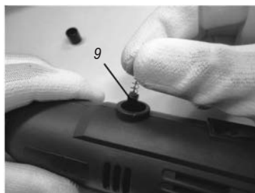
Fig. 6 – Sustitución de cepillo carbón
