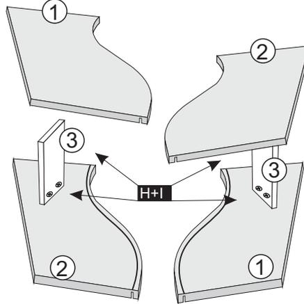
3º- FIXAR O DETALHE MAIOR SUPERIOR UTILIZANDO PARAFUSOS 07X40 CAB 10 mm
