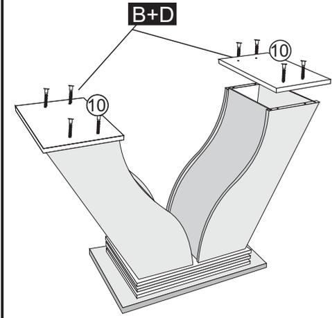
7º FIXAR O TAMPO Nº11 UTILIZANDO PARAFUSOS 04X25 CONFORME MEDIDAS ABAIXO E FIXAR NA SAPATA Nº7 AS BUCHAS AMERICANA+SAPATA REGULÁVEL.
