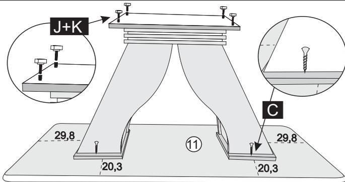
7º FIXAR O TAMPO UTILIZANDO PARAFUSOS 04X25 CONFORME MEDIDAS ABAIXO
