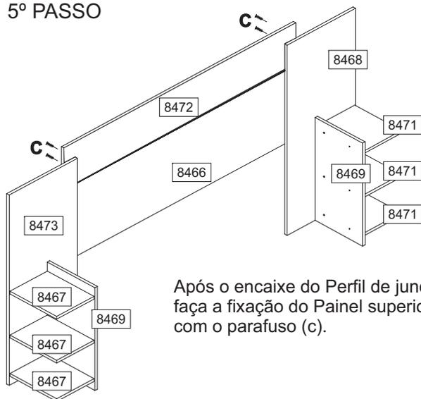
Após o encaixe do Perfil de junção, faça a fixação do Painel superior(8472) com o parafuso (c).
