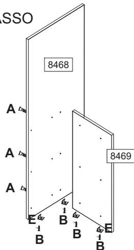
Parafuse as sapatas (E) nas laterais (8469) e nos painéis direito (8468) e esquerdo (8473) com o parafuso (B), em seguida parafuse as laterais aos painéis com o parafuso (A).
