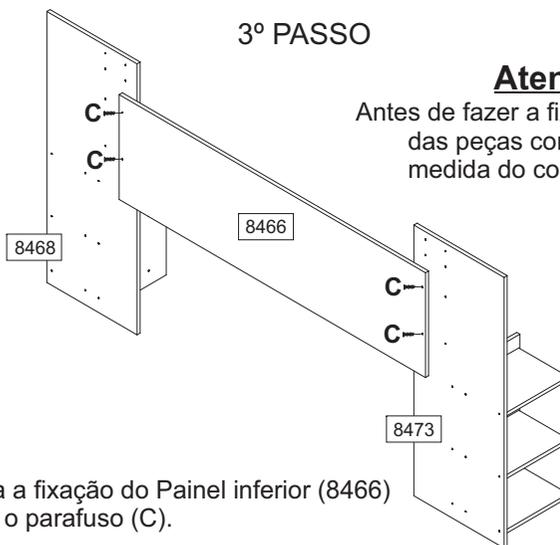
Faça a fixação do Painel inferior (8466) com o parafuso (C).
