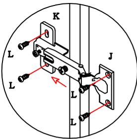
A dobradiça "J" deve ser encaixada no calço "K" e estes colocados com os parafusos "L" na porta e "N" no chapéu, observando o procedimento a cima.
