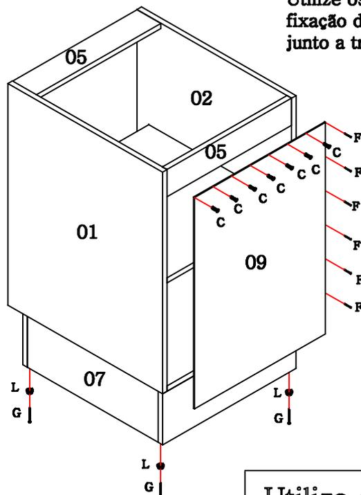
Utilize os parafusos "C" para fazer a fixação das costas na parte superior junto a travessa.
