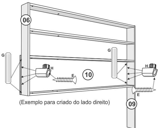
Fixar a peça 10 nas peças 06 e 09 com Cavilha, Trapézio e Parafuso 3,5x25 Painel.
