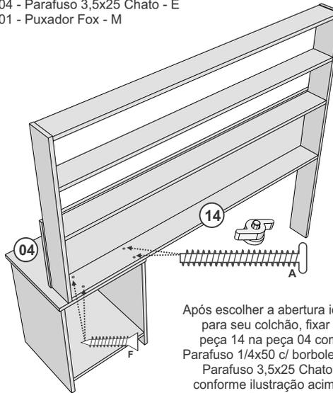
Após escolher a abertura ideal para seu colchão, fixar a peça 14 na peça 04 com Parafuso 1/4x50 c/ borboleta e Parafuso 3,5x25 Chato, conforme ilustração acima. Na opção de abertura maior, somente usar o Parafuso 6x70 c/ borboleta.
