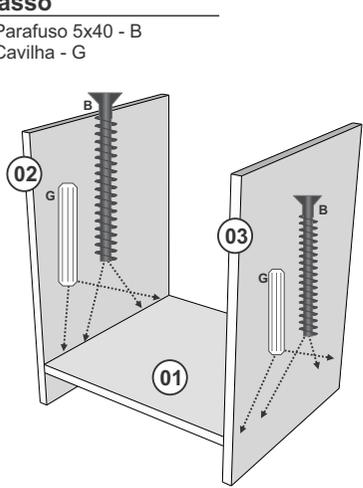
Fixar as peças 02 e 03 na peça 01 com Cavilha e Parafuso 5x40.
