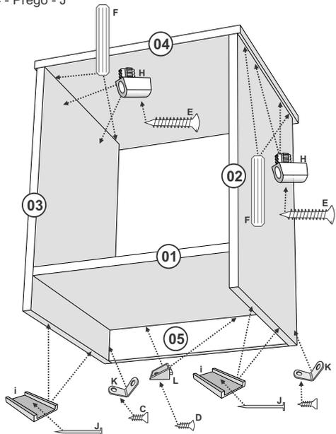
Fixar a peça 04 nas peças 02 e 03 com Cavilha e Trapézio.
