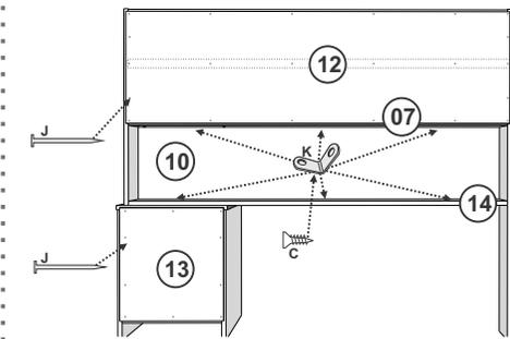
Fixar os fundos 12 e 13 com Prego. Fixar a peça 10 na peça 07 com Cantoneira metálica e Parafuso 3,5x12.
