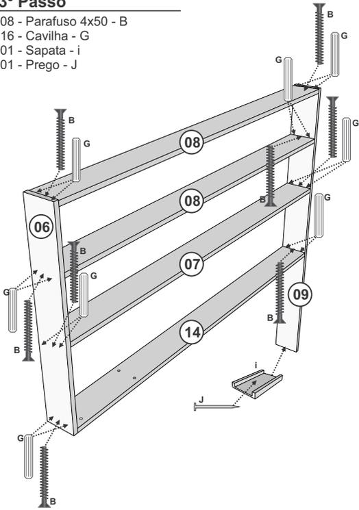
Fixar as peças 07, 08 e 14 nas peças 06 e 09 com Parafuso 5x40 e Cavilha. Fixar a Sapata com prego na peça 09.
