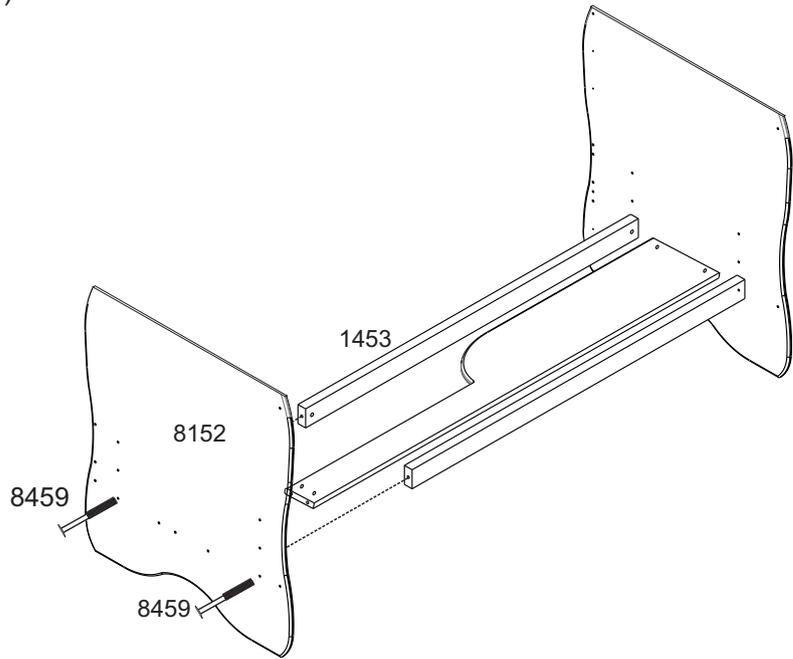
**3** Antes de fixar a grade no berço (8582), colocar as ponteiros (2122) nos topos. Em seguida, fixe a Grade do Berço (8582) às Cabeceiras (8152/8151) com o Parafuso (8459) e Porca Cilíndrica(8624).
