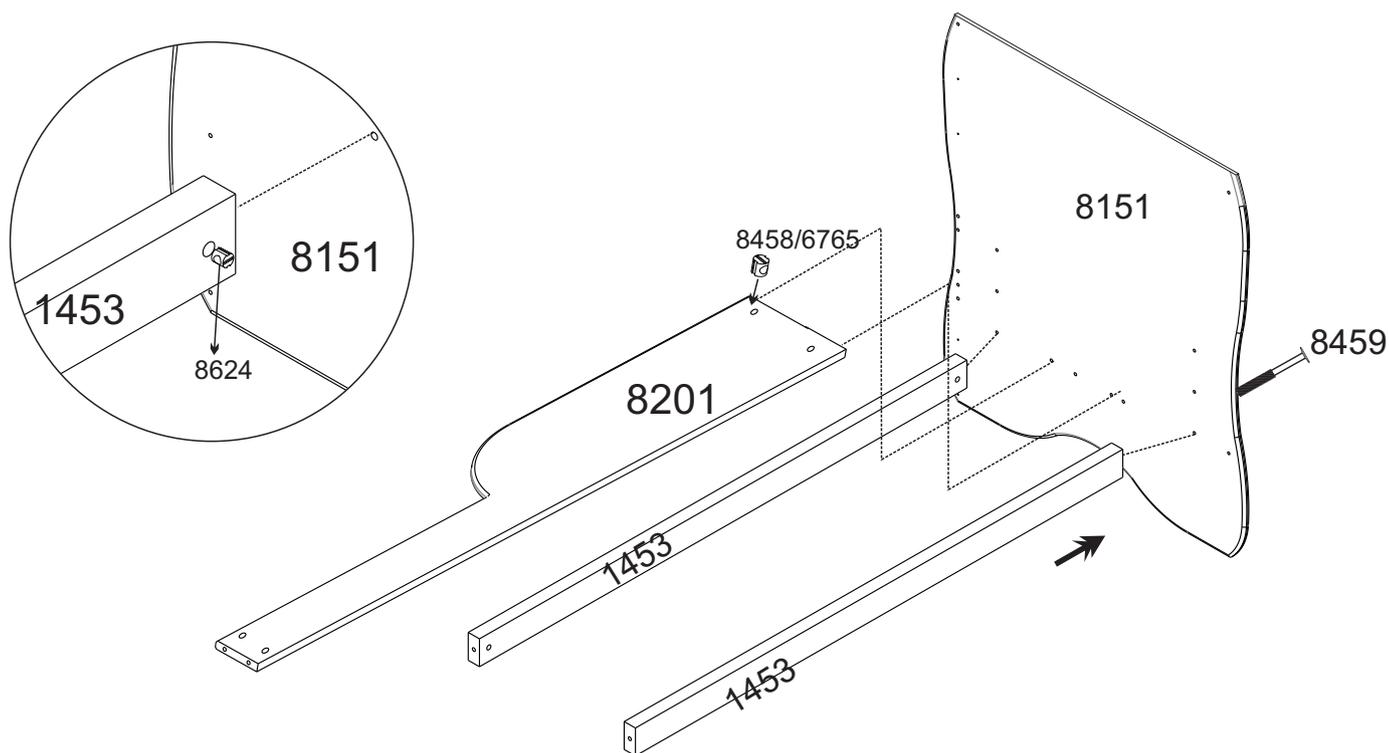
**2** Faça o mesmo passo fixando a outra Cabeceira Esquerda (8152) ao Travessão (1453), com Parafuso (8459) e Porca Cilíndrica(8624). Utilize juntamente com o Parafuso (6765) a Porca Cilíndrica (8458) na montagem da Barra da Mini Cama (8201).
