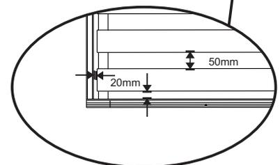
**OBS.:** Pregue as ripas próximo da grade Fixa, para não comprometer o funcionamento da grade Móvel
