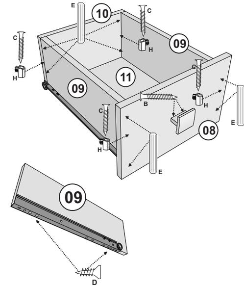
Montar a Gaveta com Cavilha e Trapézios. Fixar os Trapézios com Parafuso 3,5x25. Fixar o Puxador com Parafuso 3,5x25 Chato. Fixar as corrediças nas laterais 09 com Parafuso 3,5x12.
