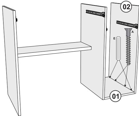
Fixar a peça 02 na peça 01 com Cavilha e Parafuso 5x40.
