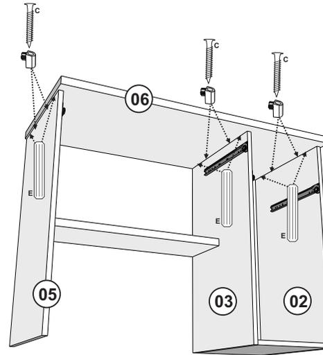
Fixar a peça 06 nas peças 02, 03 e 05 com Cavilha e fixar nos Trapézios com Parafuso 3,5x25.
