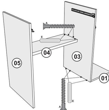
Fixar a peça 03 na peça 04 e a peça 01 na peça 03 com Cavilha e Parafuso 5x40.
