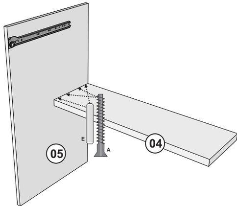
Fixar a peça 04 na peça 05 com Cavilha e Parafuso 5x40.
