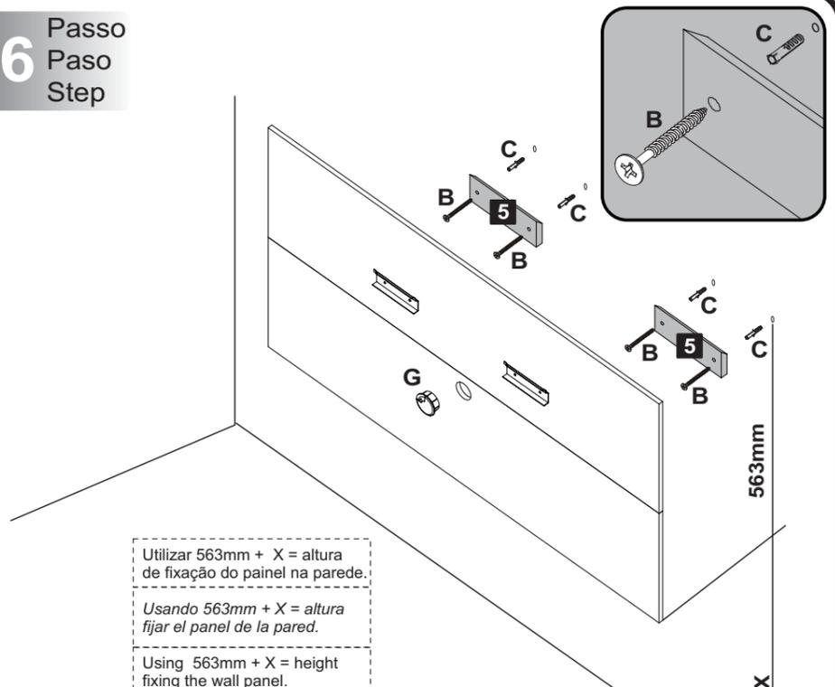
Utilizar 563mm + X = altura de fixação do painel na parede.
