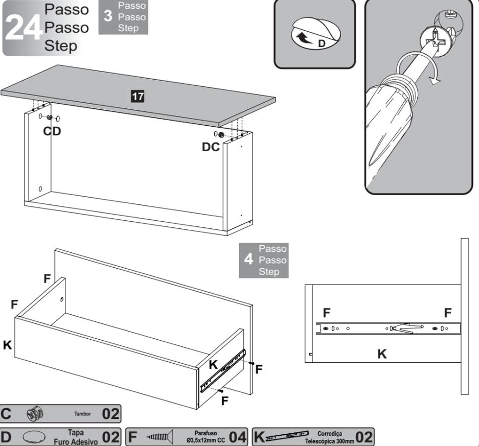
C Tambor 02 D Tapa Furo Adesivo 02 F Parafuso Ø3,5x12mm CC 04 K Corrediza Telescópica 300mm 02
