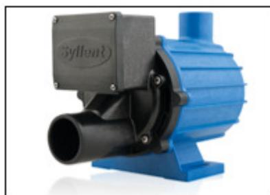
**MOTOBOMBA:** Item responsável para circulação da água na SPA. Seu design autodrenante permite o escoamento da água das tubulações e do corpo da própria bomba, evitando a ocorrência de aromas desagradáveis e desperdício de água com limpezas de tubulações, sendo também totalmente antichoque, pois é fabricada com material plástico de engenharia de forma a não permitir o contato da água com as partes metálicas do motor elétrico.
