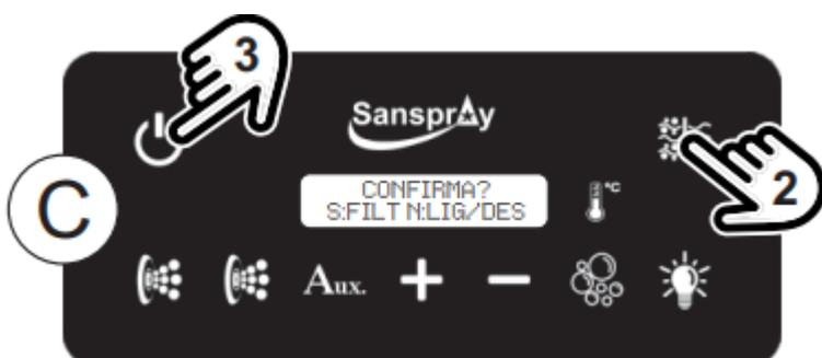
C.) Pressione filtro (2) para iniciar o processo de configuração da filtragem ou botão Liga/Desliga (3) para cancelar
