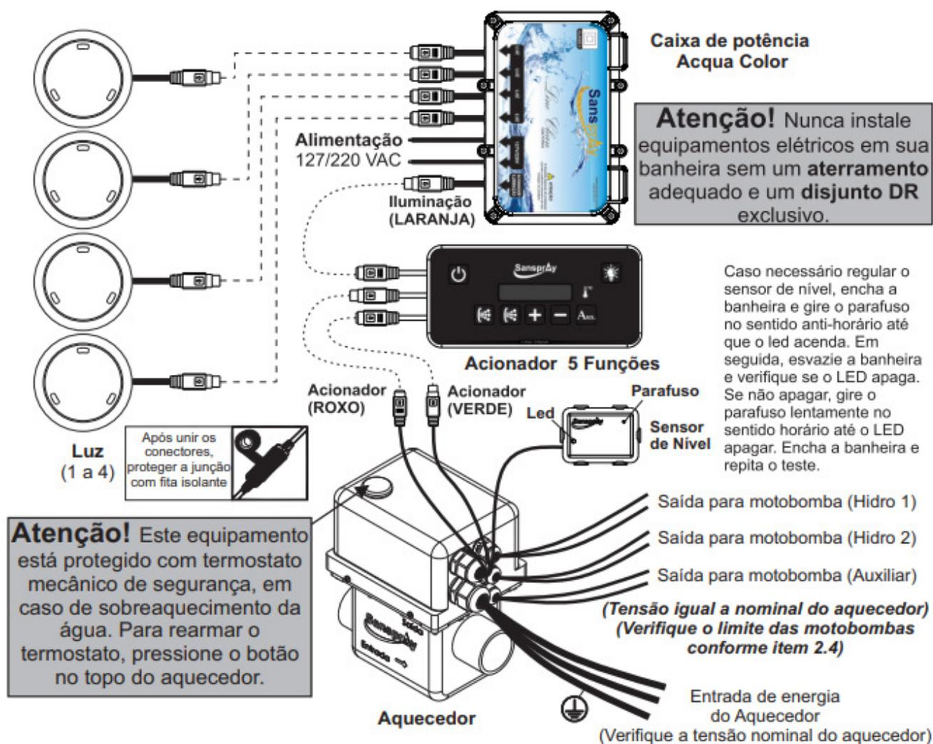
Caso necessário regular o sensor de nível, encha a banheira e gire o parafuso no sentido anti-horário até que o led acenda. Em seguida, esvazie a banheira e verifique se o LED apaga. Se não apagar, gire o parafuso lentamente no sentido horário até o LED apagar. Encha a banheira e repita o teste.
