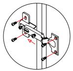
A dobradiça "N" deve ser encaixada no calço "O" e estes colocados com os parafusos "P", observando o procedimento a cima.
