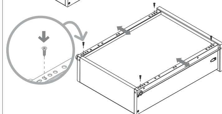
Utilize os furos de regulagem e ajuste a corrediça para a esquerda ou para a direita, conforme sua necessidade.
