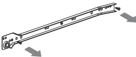
Fixe os parafusos das extremidades na furação com regulagem da corrediça, sem aperto total. Nivele a corrediça conforme a necessidade e aperte totalmente os parafusos.
