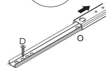
Agora deslize a parte superior da correção para trás e fixe o parafuso no primeiro furo da parte inferior da correção conforme mostra o detalhe.
