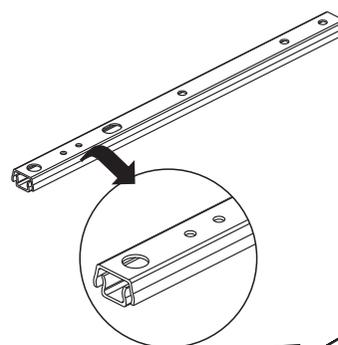
Antes de fixar a correção verifique a posição correta conforme mostra o detalhe. Veja que o topo que deve ficar para a frente possui dois furos bem próximos, esses furos devem ficar para a frente do móvel.
