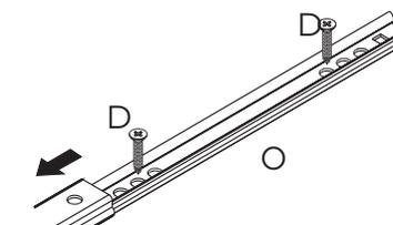
Para finalizar a fixação, deslize a parte superior da correção para a frente até chegar a sua abertura máxima liberando os furos da parte inferior da correção, agora ajuste os furos com a marcação feita na peça e fixe o restante dos parafusos conforme mostra o detalhe.
